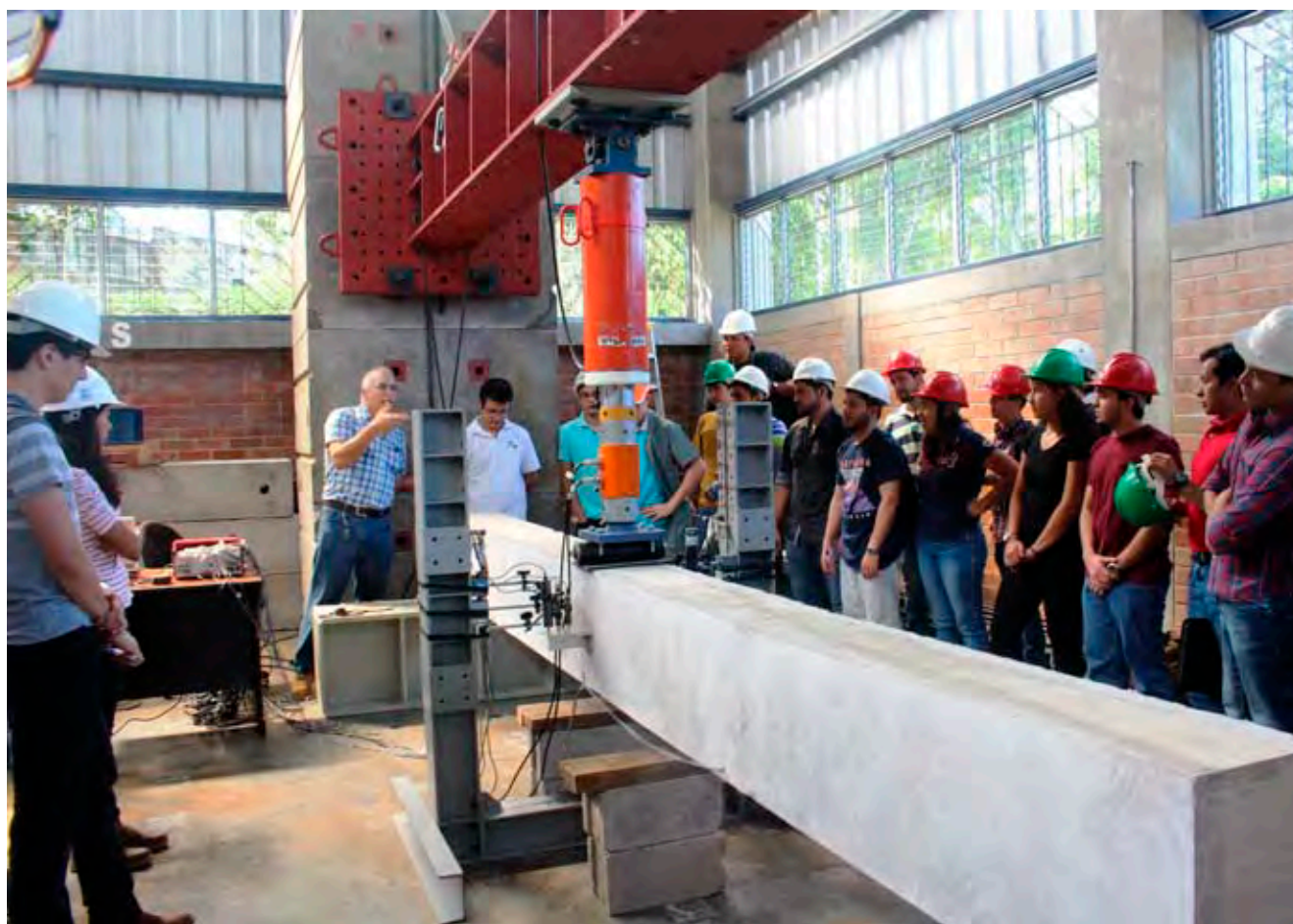
Ensayo en viga de concreto reforzado
