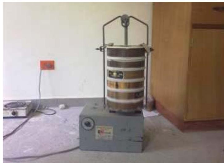
Prueba de granulometría, vibrado.
