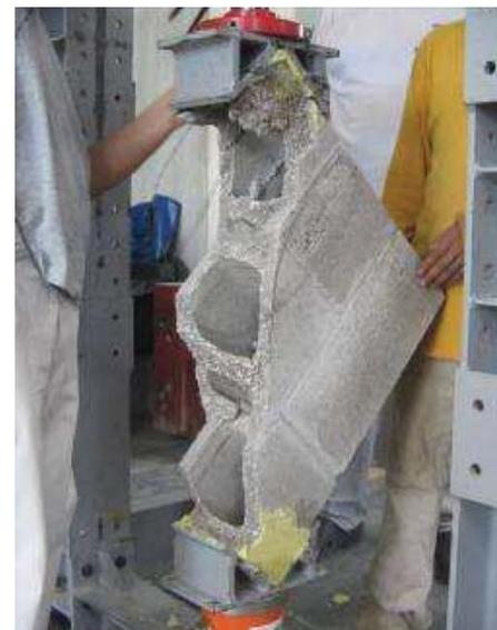
Ensayo a compresión diagonal
