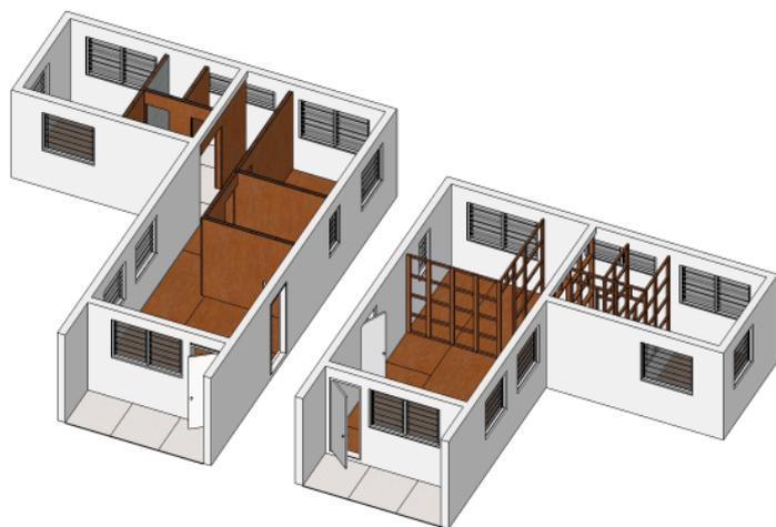
3. Colocación de piso, puertas, ventanas y paredes interiores
