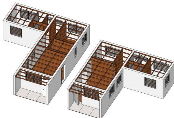
4. Instalación de estructura para entrepiso en el primer nivel
