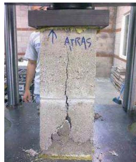
Ensayo a compresión simple
