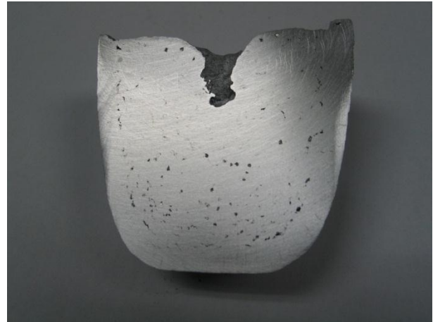
Fotografía 6. Sección transversal interna de la muestra que solidificó a presión reducida. Se observan a simple vista los poros causados por la presencia de hidrógeno.
