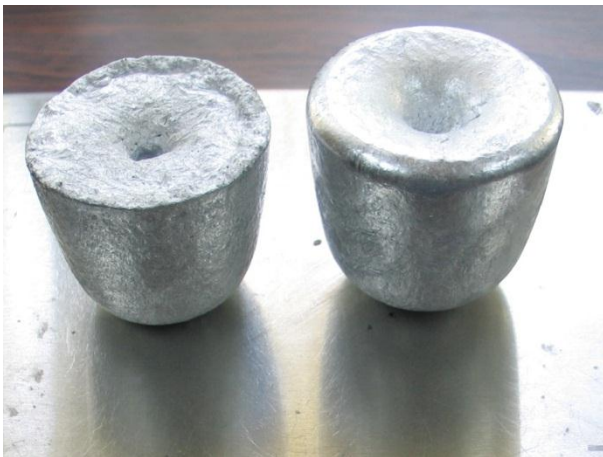
Fotografía 5. Comparación entre la pieza obtenida a presión reducida y la pieza solidificada a presión atmosférica.
