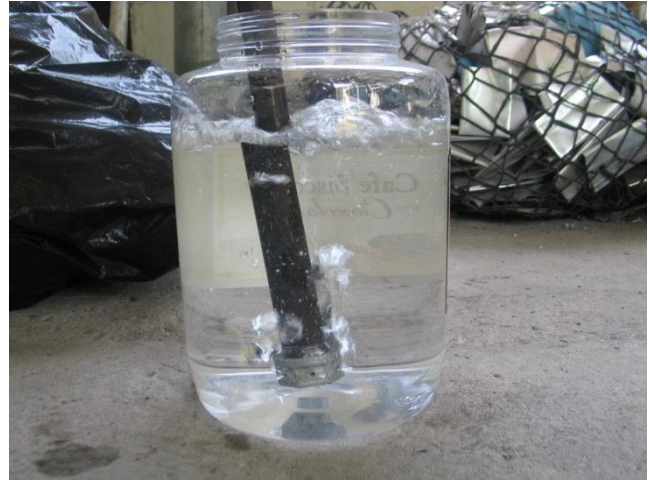
Fotografía 9. Burbujas generadas por el nitrógeno cuando se inyecta en agua.
