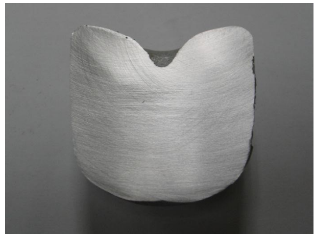
Fotografía 7. Sección transversal interna de la muestra que solidificó a presión normal. Aún cuando esta muestra está contaminada con hidrógeno, su presencia no es evidente.
