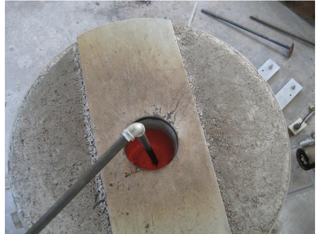
Fotografía 8. El nitrógeno se inyecta en el metal líquido por medio de una lanza fabricada con acero inoxidable.
